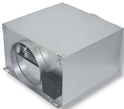
ISORX...S Delvis isoleret boksventilator, bagudkrummet ventilatorhjul, 4 trins regulering
